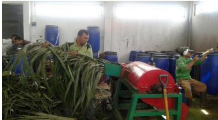
Gambar 17. Penggilingan pelepah sawit dengan menggunakan mesin Shreeder
